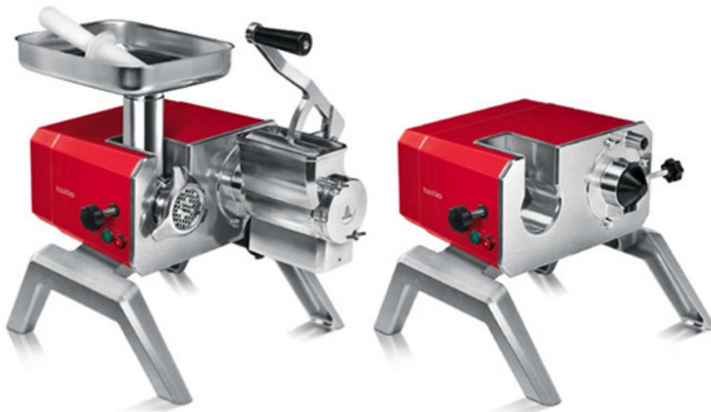
*Potenza motore: 750 W (1 hp), motore a induzione trifase 380V/50Hz (versione monofase 220V/50Hz disponibile da maggio 2013), ventola supplementare di raffreddamento per utilizzo prolungato, riduttore a bagno d'olio con ingranaggi forgiati e temprati, peso del corpo macchina 19 kg, dimensioni cm 39x40x34h.*
