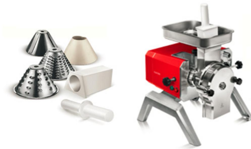
*Corpo in alluminio, tre coni di taglio in dotazione (a lame inox per fette/rondelle; inox con foro 4 mm per julienne; inox con foro 7 mm per tocchetti, perfetto per verdure, mozzarella e formaggi), sistema di sbloccaggio integrato, senza utensili, accessorio guida-verdura e presina copri-cono di sicurezza in dotazione standard, peso accessorio 2 kg, dimensioni accessorio cm 24x30x37h.*
